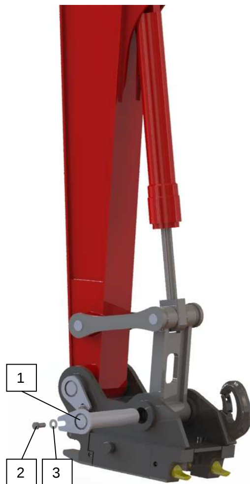
Abb. 4.3-2 Montage hinterer Bolzen
